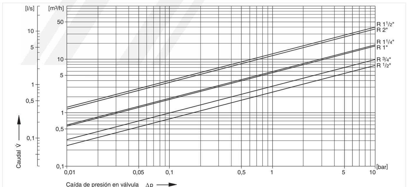
Fig. 2 Caída de presión en válvula en función del caudal y del tamaño de conexión
