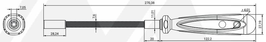
Destornillador utilizado básicamente para las abrazaderas ASFA L y S.
