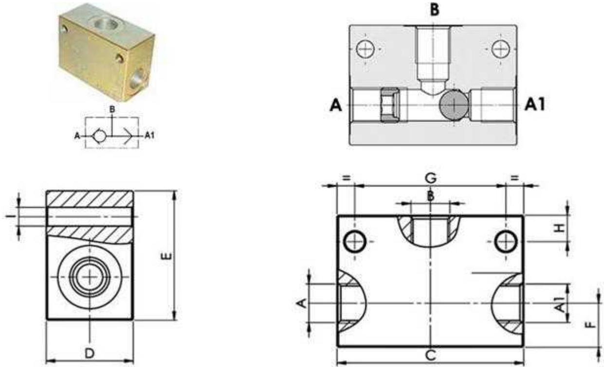
**Materiales:** Cuerpo y partes interiores en acero. La superficie externa zincada.
