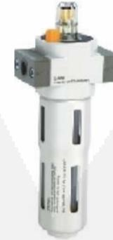
El lubricador directo de densidad constante agrega una cantidad regulada de aceite al aire comprimido. Una válvula mantiene el contenido de niebla de aceite proporcional al flujo de aceite comprimido.
