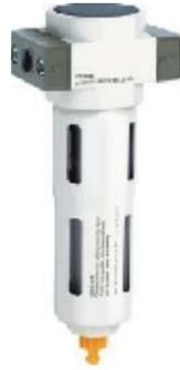
El OF con separador de agua limpia el aire comprimido de la condensación de aceite fluido y las partículas de suciedad para aplicaciones especiales; el elemento filtrante estándar de 40 µm se puede reemplazar fácilmente por un elemento filtrante de 5 µm.
